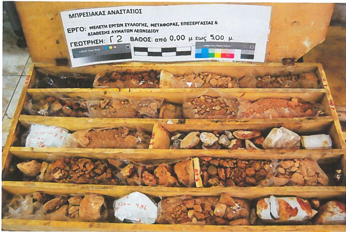
Φωτ.5. Δειγματοληπτική γεώτρηση Γ2. Βάθος 0,00 – 5,00m.
