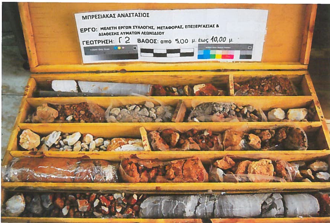
Φωτ.6. Δειγματοληπτική γεώτρηση Γ2. Βάθος 5,00 – 10,00m
