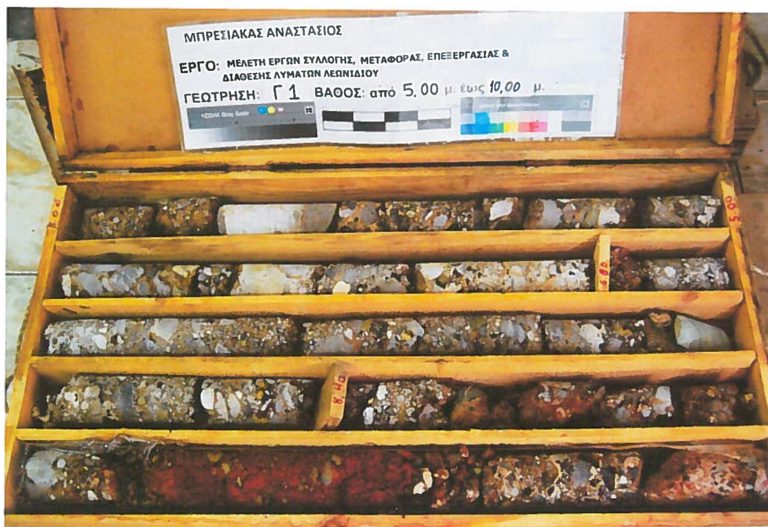
Φωτ.3. Δειγματοληπτική γεώτρηση Γ1. Βάθος 5,00 – 10,00m.
