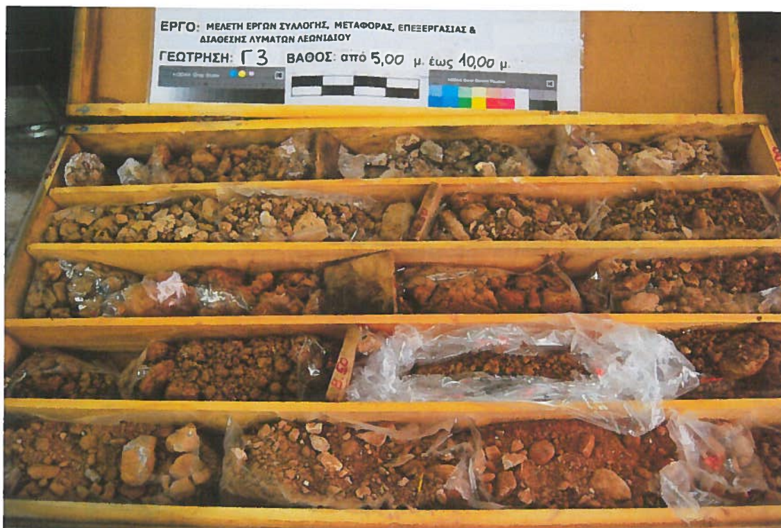
Φωτ.9. Δειγματοληπτική γεώτρηση Γ3. Βάθος 5,00 – 10,00m.
