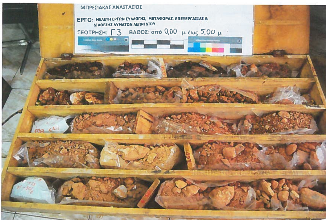
Φωτ.8. Δειγματοληπτική γεώτρηση Γ3. Βάθος 0,00 – 5,00m.
