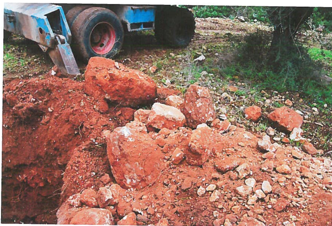
Φωτ.21. Δειγματοληπτικό φρέαρ ΕΦ3. Ασβεστολιθικοί ογκόλιθοι.
