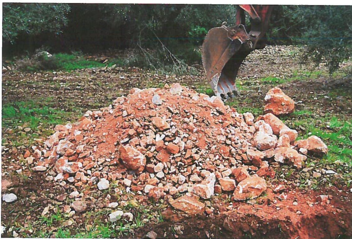
Φωτ.18. Δειγματοληπτικό φρέαρ ΕΦ2. Διακρίνονται οι ασβεστολιθικής σύστασης ογκόλιθοι.
