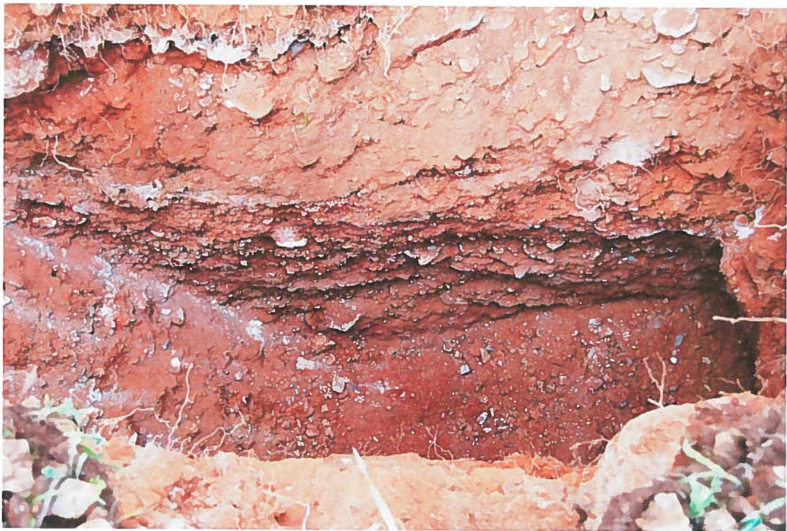
Φωτ.15. Δειγματοληπτικό φρέαρ ΕΦ1. Διακρίνονται στα υλικά εκσκαφής ασβεστολιθικοί ογκόλιθοι.
