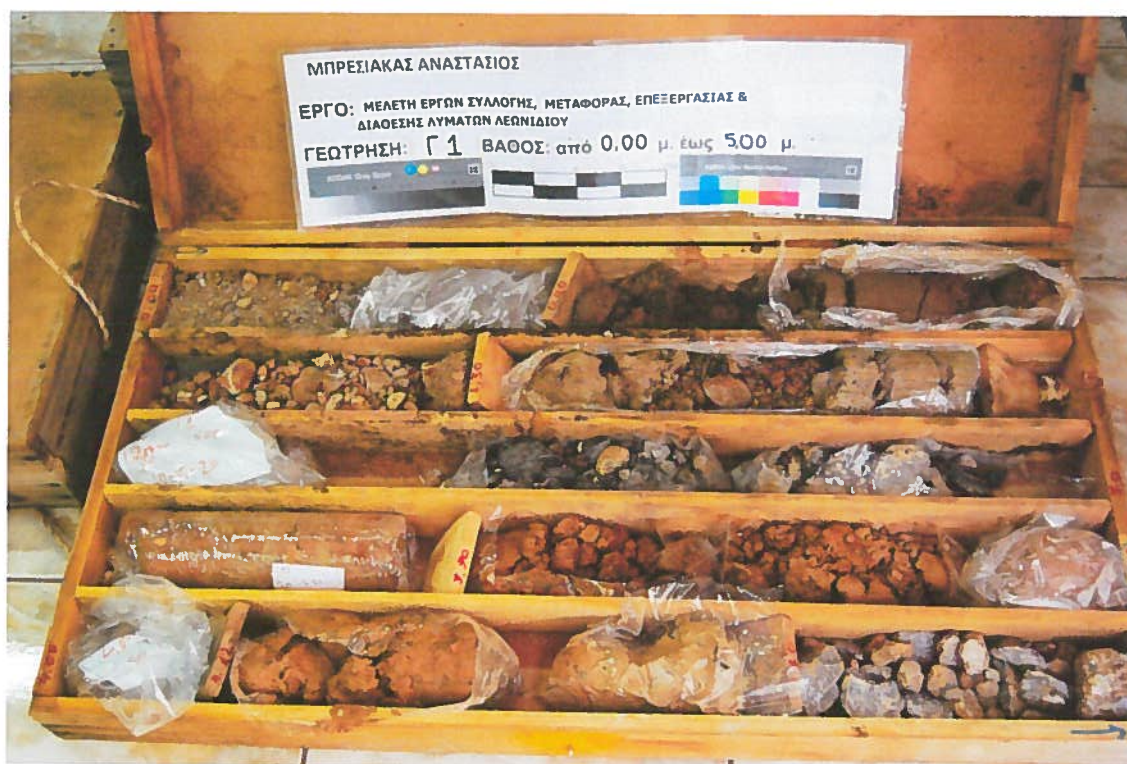
Φωτ.2. Δειγματοληπτική γεώτρηση Γ1. Βάθος 0,00 – 5,00m.
